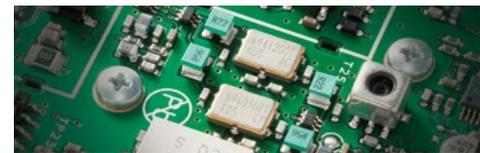
3 kHz- und 15 kHz Roofing-Filter
